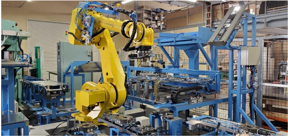
写真-1 全自動成型ライン(S-MARC)
